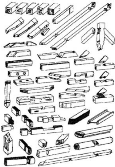
图 1 CNC 加工的部分木构件
